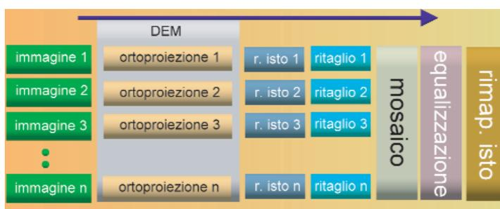
Figura 3 - Pipeline per la generazione di un ortomosaico
